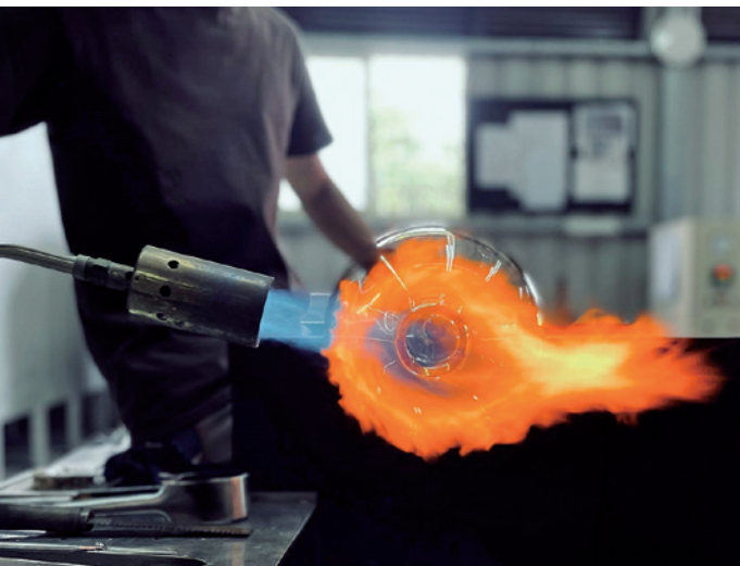
在火焰上熔接玻璃講求迅速，稍一躊躇，便容易因冷熱不均而引起爆裂。
