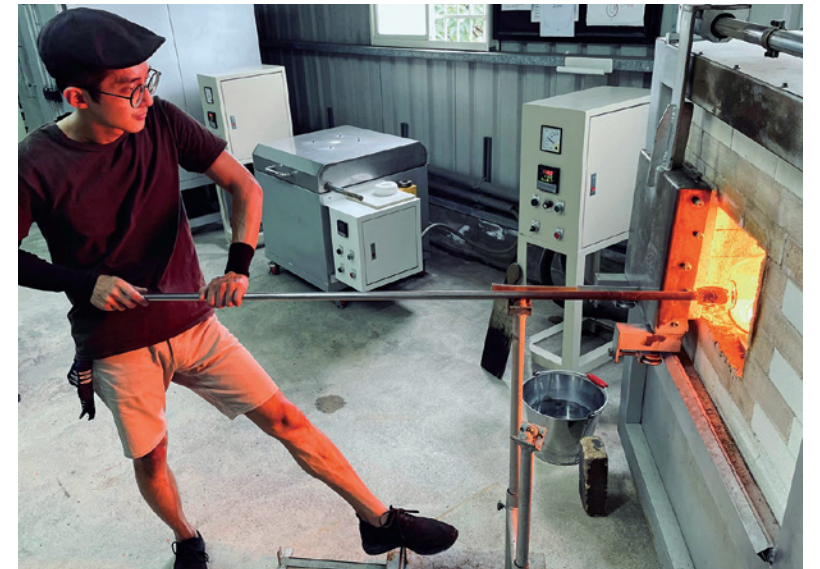
玻璃在火中燃燒過久易生雜質而影響美觀，若非技術熟練精湛，實難將火候、時間控制得恰到好處。
